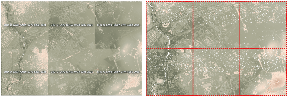
Fig. 24.44: Generazione di nuvole di punti virtuali con visualizzazione da un insieme di tasselli di nuvole di punti
