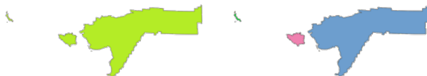
Fig. 24.124: A sinistra il layer multiparte di origine e a destra il risultato in uscita a parte singola
