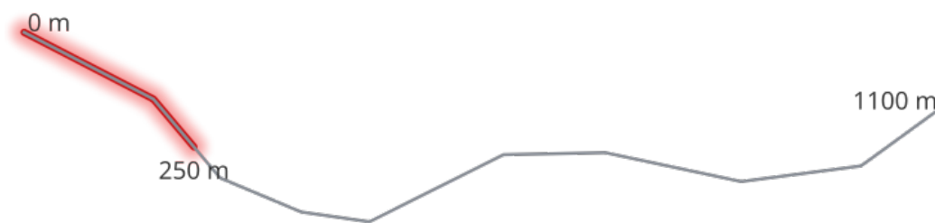
Fig. 9.21: Linea sottostringa con distanza iniziale impostata a 0 metri e distanza finale a 250 metri.
