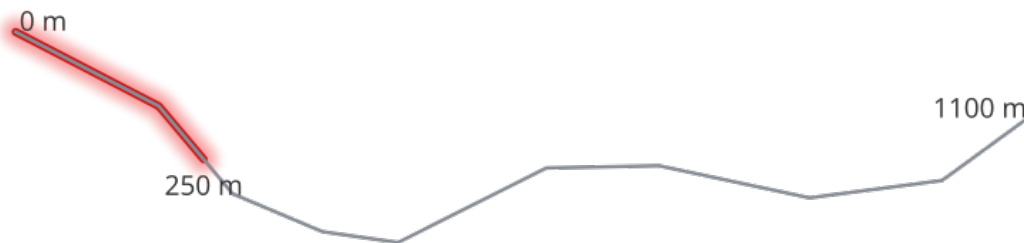
Fig. 24.120: Linea sottostringa con distanza iniziale impostata a 0 metri e distanza finale a 250 metri.
