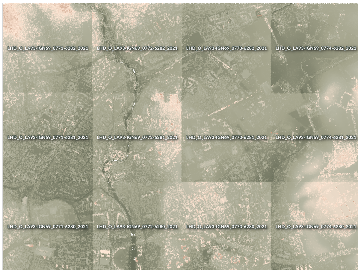
Fig. 16.15: Caricamento di singoli tasselli della nuvola di punti, con artefatti sui bordi
