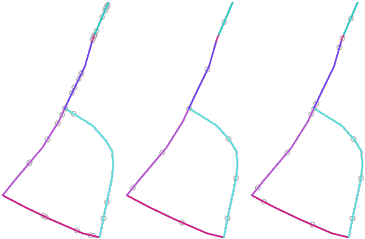
Fig. 24.84: Cinque punti per elemento linea, a sinistra : min. distanze = 0, al centro : min. distanze != 0, a destra : min. distanza != 0, min. distanza globale = 0
