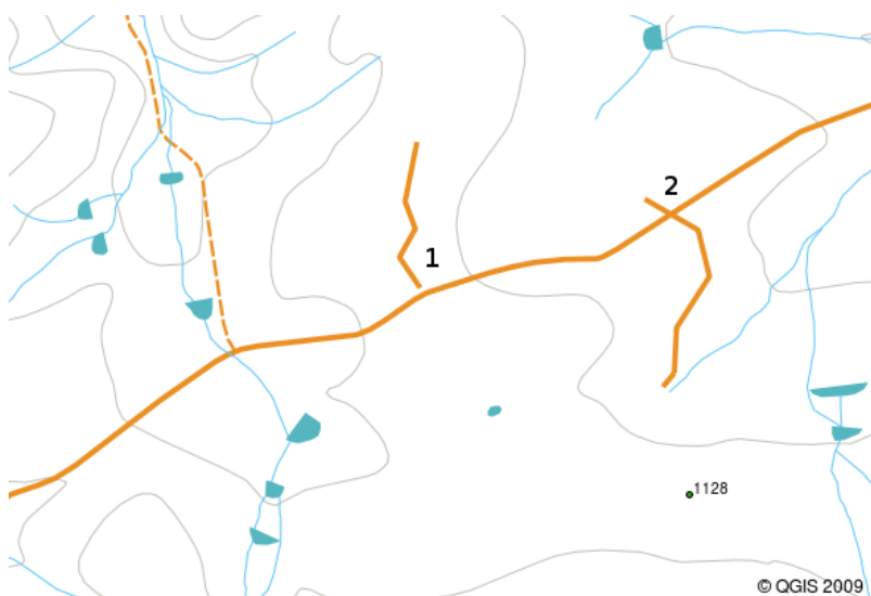
Fig. 3.13: Undershoots (1) uppstår när digitaliserade vektorlinjer som ska ansluta till varandra inte riktigt rör vid varandra. Overshoots (2) inträffar om en linje slutar bortom den linje som den ska ansluta till.
