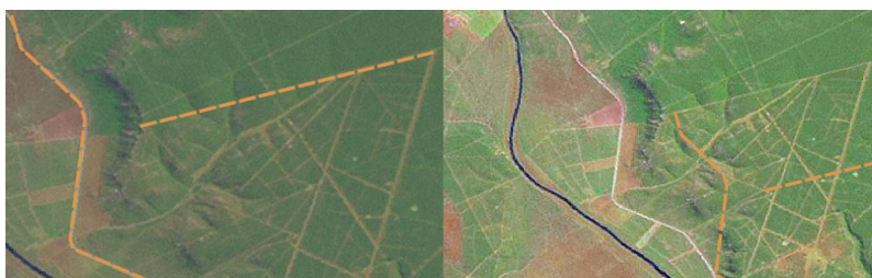
Fig. 5.9: Importanța utilizării imaginilor raster, corect georeferențiate, în digitizarea dirijată. În stânga se poate vedea că imaginea este afișată corect iar entitățile rutiere (în portocaliu) se suprapun perfect. Dacă precizia georeferențierii este scăzută (așa cum se arată în partea dreaptă), entitățile nu vor fi bine aliniate. Mai rău, în cazul în care imaginea din dreapta este utilizată ca referință, este faptul că entitățile spațiale nou capturate vor fi inexacte!
