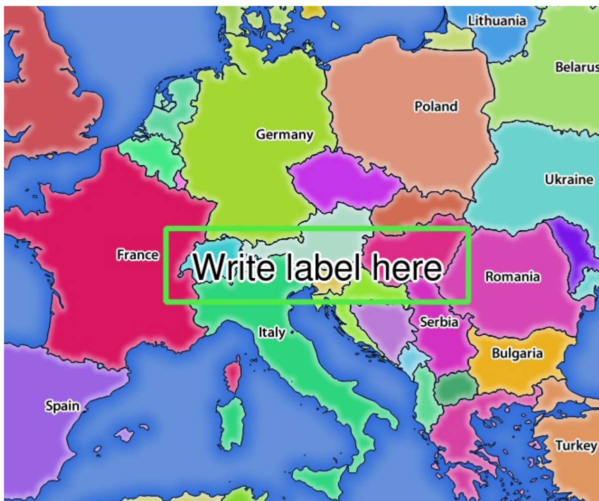
図 3.22: 赤線引きパラメータを含む GetMap リクエストに対するサーバーの応答
