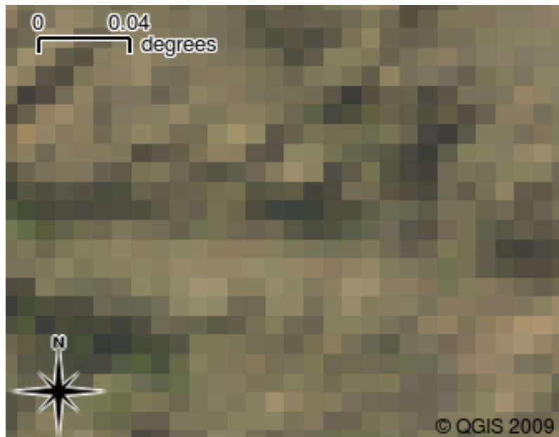
Fig. 2.13: Gli stessi dati raster, ma questa volta ingranditi. Si può vedere la natura della griglia dei dati.
