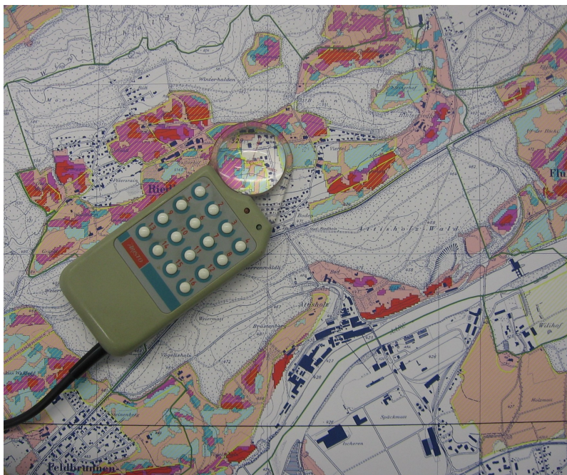
Obr. 5.8: Digitalizační tabulka a puck jsou používány GIS profesionály když chtějí digitalizovat prvky z existující mapy.
