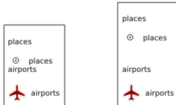
Figura3.7: Para a esquerda LAYERSPACE=0 e para a direita LAYERSPACE=10
