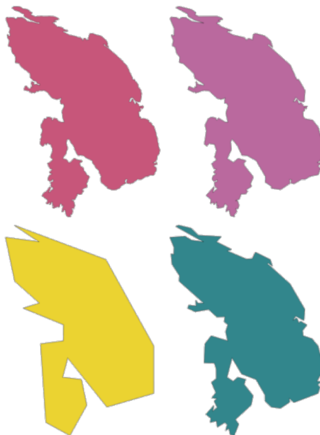
Figura28.105: No sentido horário do canto superior esquerdo: camada fonte e aumento das tolerâncias de simplificação.
