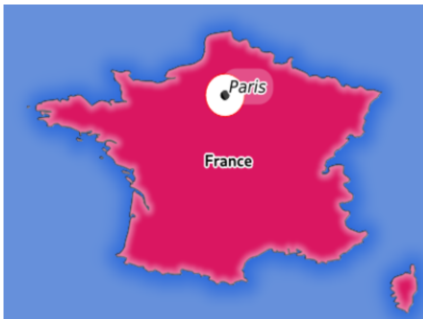
Fig. 3.3: Antwoord van de server voor een verzoek GetMap met parameter FILTER
