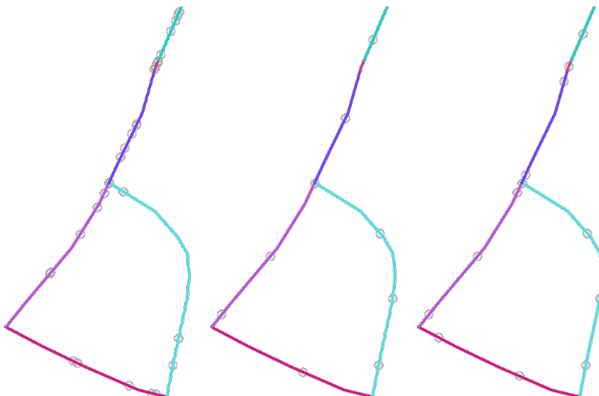
Fig. 28.53: Vijf punten per object lijn, links : min. afstanden = 0, midden : min. afstanden != 0, rechts : min. afstand != 0, globale min. afstand = 0
