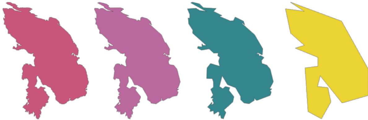
Fig. 28.105: Met de klok mee vanaf linksboven: bronlaag en vergrotende toleranties voor vereenvoudiging
