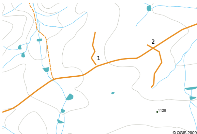
図 3.13: アンダーシュート (1) は互いに接合すべきライン地物をぴったり接合せずにデジタイズを行うと発生します。オーバーシュート (2) は接合すべきラインの端点が接合対象の地物を飛び越え交差してしまった際に発生します。
