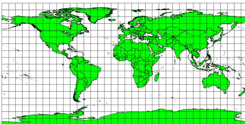
Fig. 8.4: La proiezione cilindrica equidistante Plate Carrée, ad esempio, viene adottata qualora sia importante la misura esatta delle distanze.
