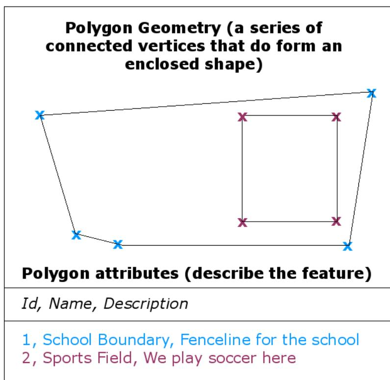
Fig. 3.4: Un poligono, come una polilinea, è una sequenza di vertici. In un poligono, il primo e l'ultimo vertice sono sempre nella stessa posizione.
