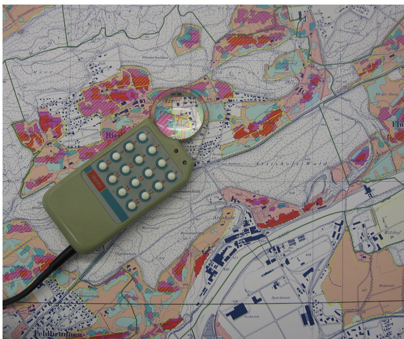
Figura 5.8: Una tabla digitalizadora y un puck son usados por los profesionales en SIG cuando quieren digitalizar rasgos de mapas existentes.
