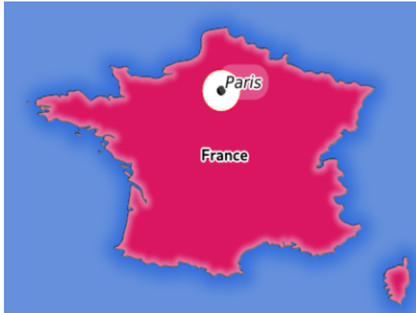
図 3.3: FILTER パラメータを指定した GetMap リクエストに対するサーバーの応答
