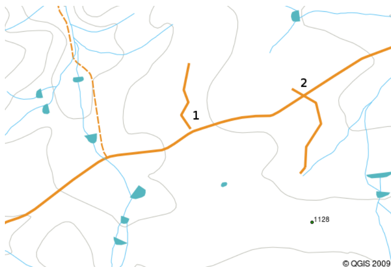
図 3.13: アンダーシュート (1) は互いに接合すべきライン地物をびったり接合せずにデジタイズを行うと発生します。オーバーシュート (2) は接合すべきラインの端点が接合対象の地物を飛び越え交差してしまった際に発生します。
