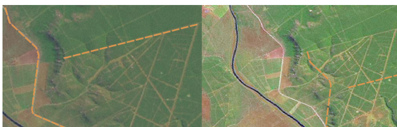
Fig. 5.9: L'importanza di utilizzare correttamente immagini raster georeferenziate per la digitalizzazione Heads-up. A sinistra possiamo vedere che l'immagine è correttamente georeferenziata e le geometrie stradali (in arancione) si sovrappongono perfettamente. Se l'immagine non è georeferenziata (come mostrato a destra), le geometrie non saranno ben sovrapposte. Peggio ancora, se l'immagine a destra viene utilizzata come riferimento quando si acquisiscono nuove geometrie, i dati appena acquisiti saranno imprecisi!
