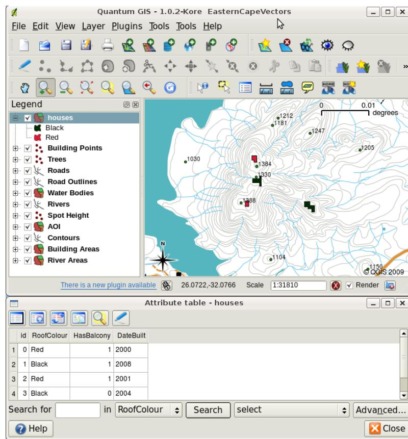
図 4.3: 家のレイヤ。家の地物には、屋根の色等の属性やその他属性情報が記述されています。属性テーブル（下図）には、地図上に示された家エリアの属性のリストが示されています。地物がテーブルの中で強調表示されているときは、地図上では黄色のポリゴンとして見えるでしょう。
