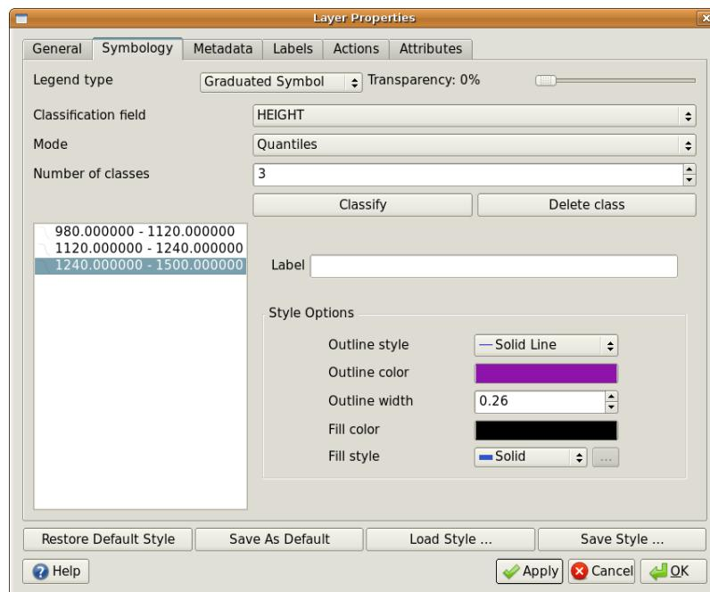
図 4.9: 等高線の高さ属性は 3 クラスに等高線を分離するために使用できます。980 メートルと 1120 メートルの間の等高線は褐色、1120 メートルと 1240 メートルの間は緑、1240 メートルと 1500 メートルの間は紫で描画されます。
