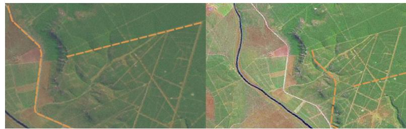
図 5.9: ヘッドアップデジタイジングのために適切にジオリファレンスされたラスタ画像を使用することの重要性。左側には適切に地理記録された道路の地物（オレンジ色）が完全に重なっている画像を見ることができます。（右図のように）画像が下手にジオリファレンスされた場合、地物は十分に揃いません。さらに悪いことに、新しい地物をキャプチャする場合に右の画像が参照として使用される場合、新しく取得されたデータは不正確になります！
