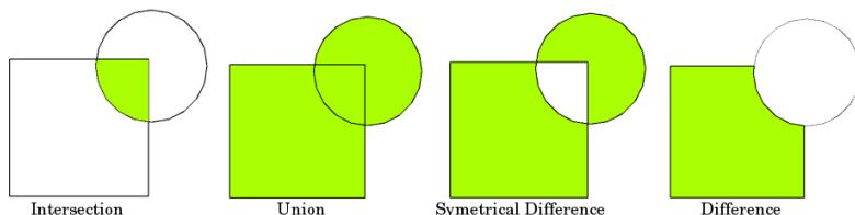
図 10.8: 2 つのベクタレイヤ ( $a\_input =$  方形、 $b\_input =$  円) の空間オーバーレイ。結果のベクタレイヤは緑で表示されます。
