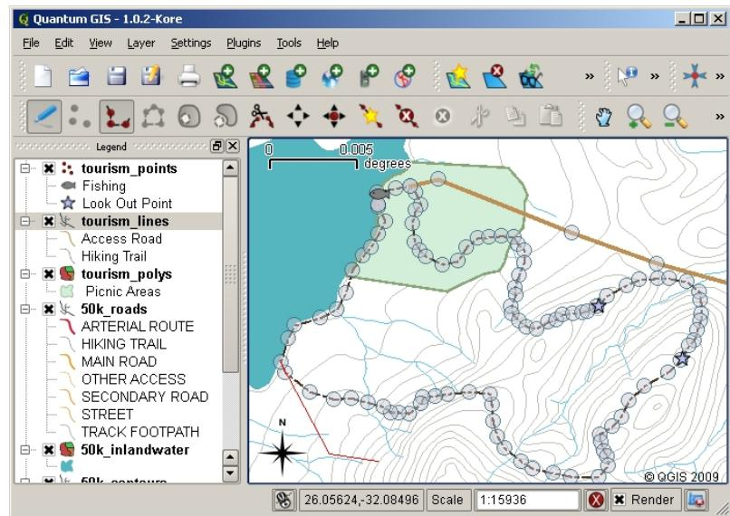
図 5.6: 観光地図のラインをキャプチャします。ラインレイヤを編集する場合、頂点はラインのジオメトリを調整するために、マウスで動き回ることができます。円形のマーカーで示されています。(赤で表示) 新しい行を追加する場合は、マウスをクリックするたびに、新しい頂点を追加します。
