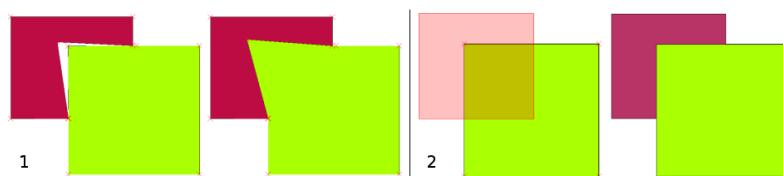
[図 7.3: \(1\)](#) 頂点を移動しているとき、共有の境界を検出するトポロジ的編集。頂点を移動しているときは、その頂点を共有するすべての地物が更新されます。[\(2\)](#) ポリゴンの重なりを回避するために、新たなポリゴンはデジタル化される（赤色で表示）とき、重なっている隣接する領域が重ならないようにクリップされます。
