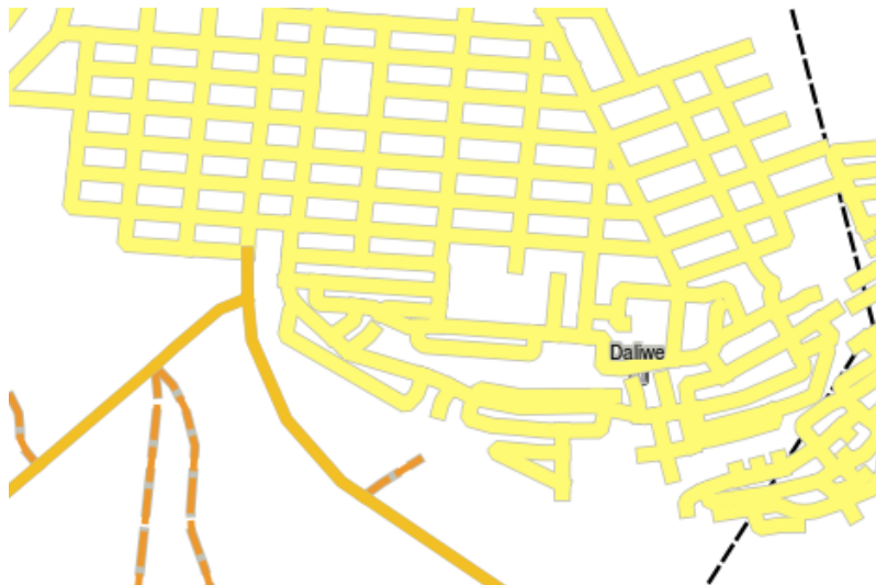
Fig. 4.14: Un layer vettore di strade simboleggiato utilizzando un valore univoco per tipo di strada.
