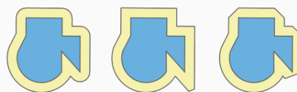
Fig. 28.45: Stili di giunzione arrotondati, a mitria e smussati
