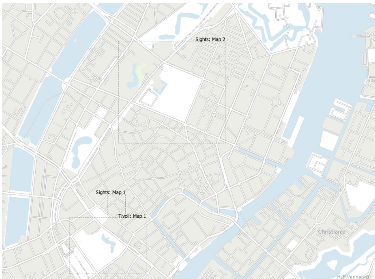
Fig. 11.11: Esempio estensioni layout visualizzati in un progetto QGIS con due layout di stampa. Il layout di stampa denominato “Sights” contiene due oggetti nella mappa, mentre l’altro layout di stampa contiene un oggetto nella mappa.
