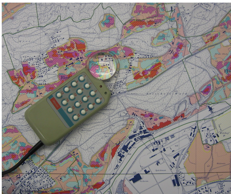
Figura5.8: Uma mesa de digitalização e mira são usadas por profissionais SIG quando têm que digitalizar elementos a partir de mapas existentes.
