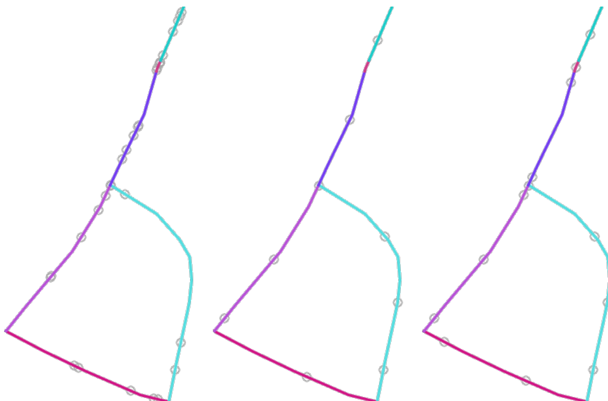
Figure 28.53: cinq points par ligne, gauche : distances minimales = 0, milieu : distances minimales != 0, droite : distance minimale != 0, distance minimale globale = 0.
