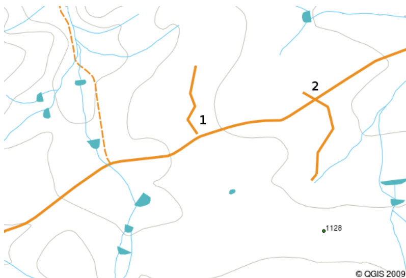
Fig. 3.13: I difetti (1) appaiono quando le linee vettoriali digitalizzate che dovrebbero connettersi con le altre non si toccano. Le eccedenze (2) si hanno se una linea termina oltre la linea alla quale dovrebbe connettersi.
