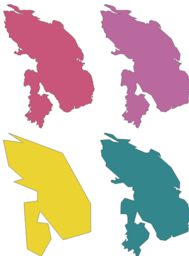
Fig. 28.105: In senso orario dall'alto a sinistra: layer di origine e aumento delle tolleranze di semplificazione
