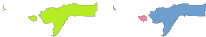
Fig. 28.93: A sinistra il layer multiparte di origine e a destra il risultato in uscita a parte singola
