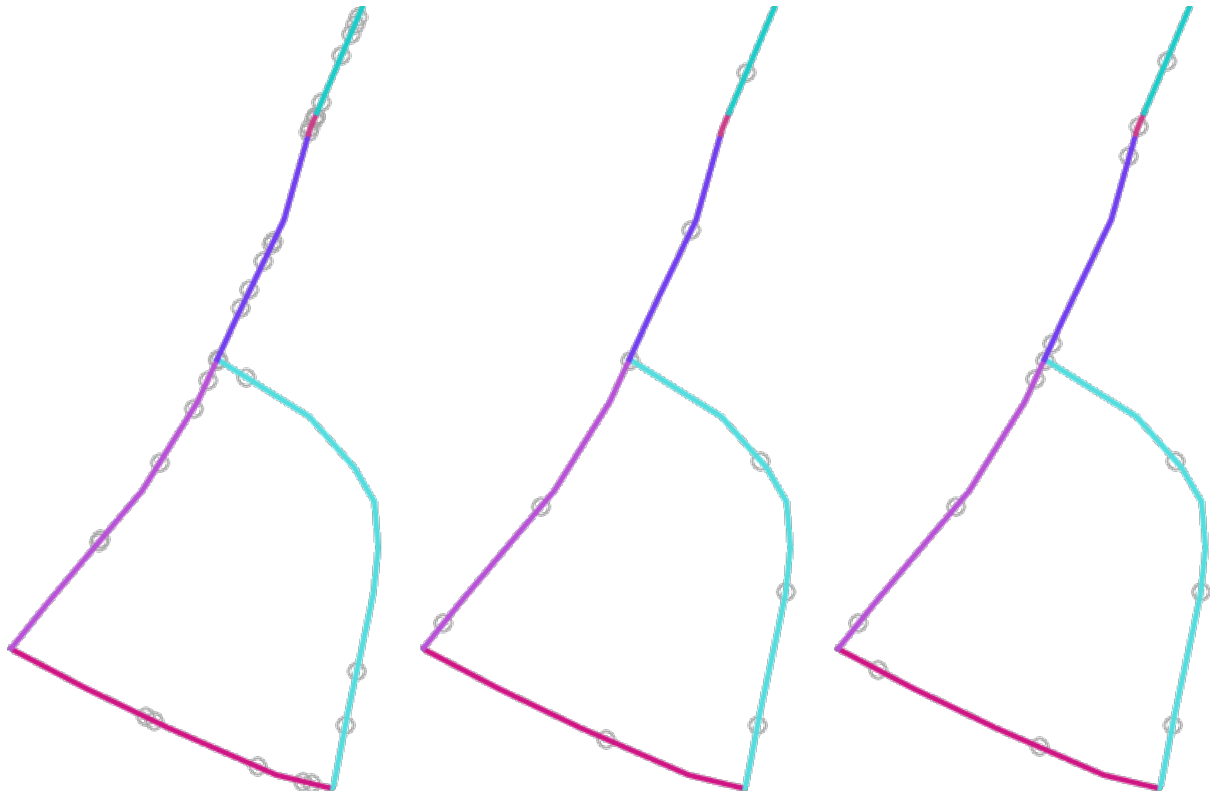
Fig. 28.53: Cinque punti per elemento linea, a sinistra : min. distanze = 0, al centro : min. distanze != 0, a destra : min. distanza != 0, min. distanza globale = 0
