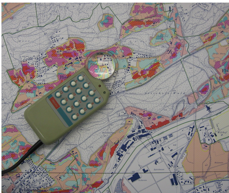
Рис. 5.8: Графический планшет и шайба используются ГИС-профессионалами при оцифровке объектов с существующих карт.
