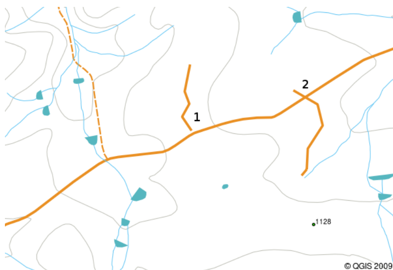
Рис. 3.13: Недоводы (1) возникают при оцифровке линий, которые должны быть соединены, но не смотря на это не соприкасаются. Перехлесты (2) возникают когда линия пересекает другую линию, с которой она должна была быть соединена.
