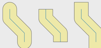
Fig. 28.9: Ronde, vlakke en vierkante eindstijlen
