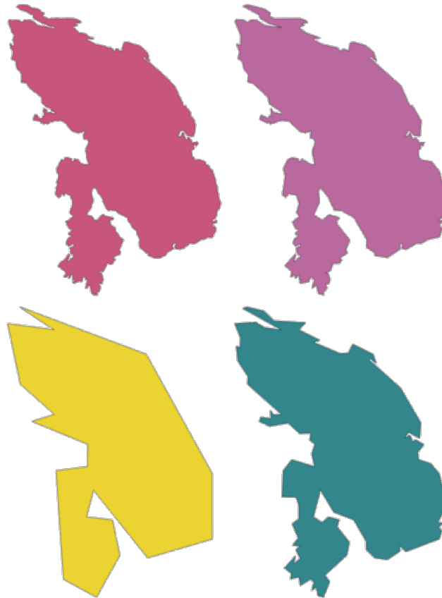
Fig. 28.105: Met de klok mee vanaf linksboven: bronlaag en vergrotende toleranties voor vereenvoudiging
