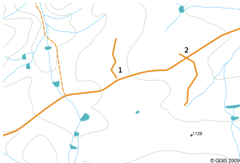
Figura 3.13: Undershoots (1) ocurre cuando las líneas vectoriales digitalizadas que deben conectarse con otras no hacen contacto del todo. Overshoots (2) ocurren si una línea termina más allá de la línea a la que debe conectarse.
