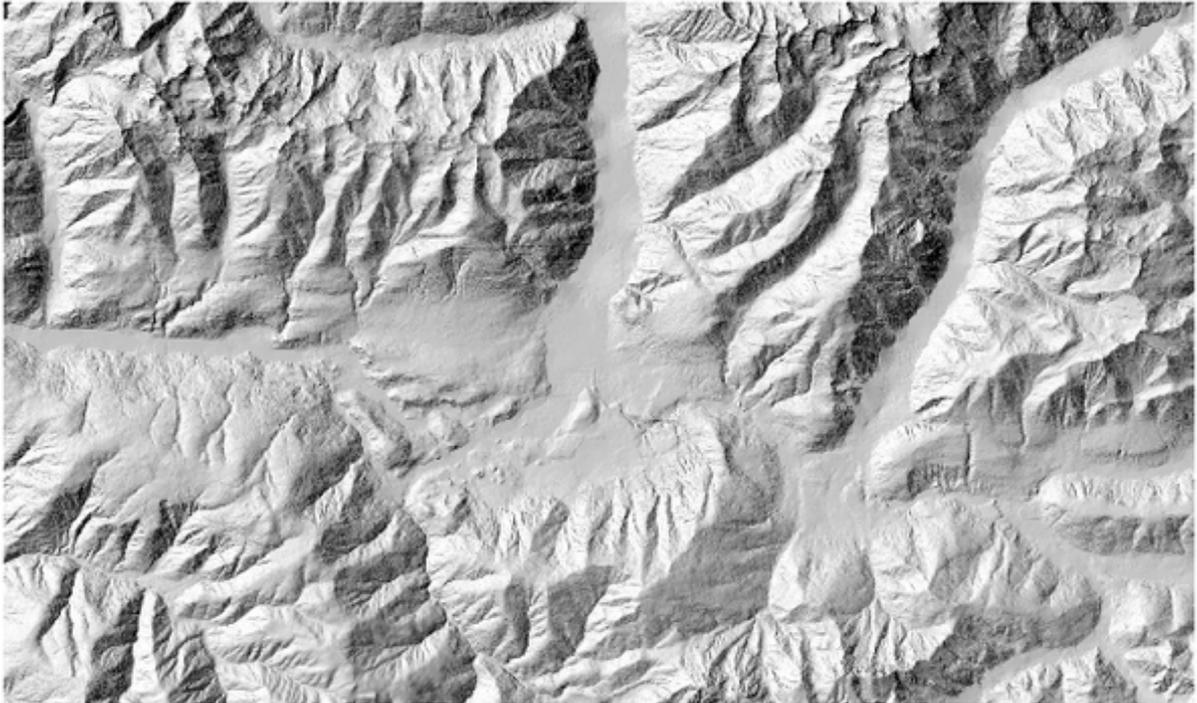
Figura 28.32: Capa de sombreado con azimut 300 y ángulo vertical de 45
