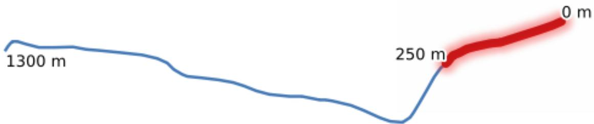
Figura 28.89: Línea de subcadena con distancia de inicio establecida a 0 metros y distancia de finalización a 250 metros.
