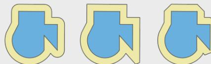
Figura 28.107: Estilos de unión redonda, a inglete y en bisel
