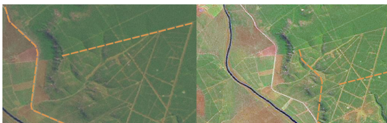
Fig. 5.9: Importanța utilizării imaginilor raster, corect georeferențiate, în digitizarea dirijată. În stânga se poate vedea că imaginea este afișată corect iar entitățile rutiere (în portocaliu) se suprapun perfect. Dacă precizia georeferențierii este scăzută (așa cum se arată în partea dreaptă), entitățile nu vor fi bine aliniat. Mai rău, în cazul în care imaginea din dreapta este utilizată ca referință, este faptul că entitățile spațiale nou capturate vor fi inexacte!
