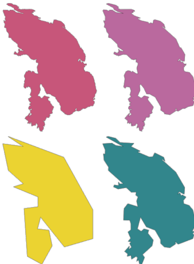
Figura 28.105: En sentido horario desde esquina superior izquierda: capa fuente e incremento de tolerancias de simplificación
