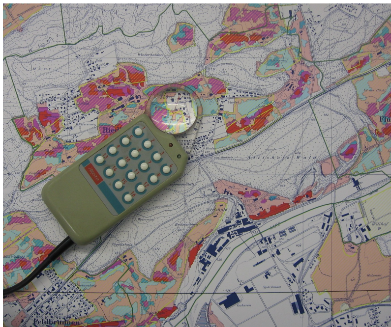
Figura5.8: Uma mesa de digitalização e mira são usadas por profissionais SIG quando têm que digitalizar elementos a partir de mapas existentes.
