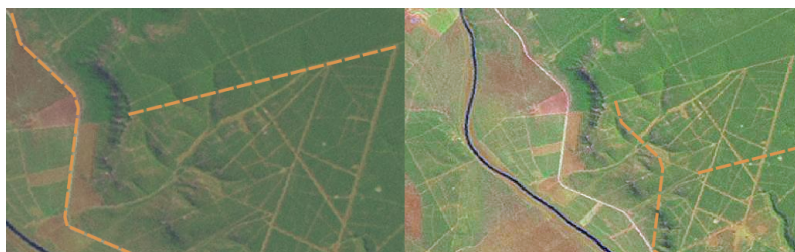
Figura5.9: A importância de usar imagens matriciais adequadamente bem georreferenciadas para digitalização na tela. Na esquerda podemos ver que a imagem está adequadamente bem registada e que os elementos da estrada (em laranja) sobrepõem-se perfeitamente. Se uma imagem estiver fracamente georreferenciada (como é mostrado na direita) os elementos não serão bem alinhados. Mais grave ainda, se a imagem da direita for usada como referência aquando da captura de novos elementos, os novos dados capturados serão inexatos!
