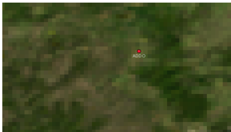
Figura6.6: ... mas se visualizada em uma escala grande você poderá visualizar os pixels individualmente na composição da imagem.
