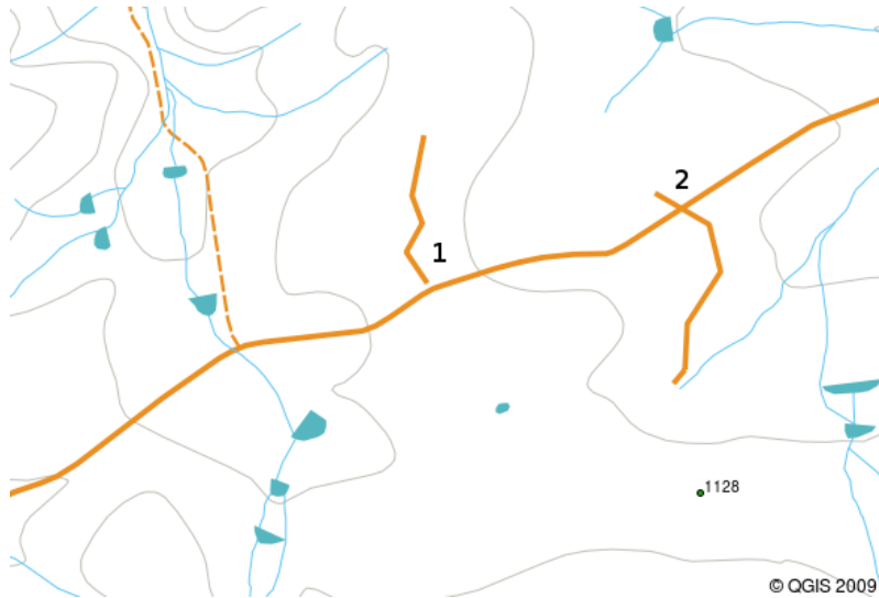
그림 3.13: 연결 되어야 할 디지털화된 벡터 라인들이 제대로 접하지 않는 경우 언더슈트 (1) 이 생겨납니다. 어떤 라인이 연결되어야 하는 라인 너머에서 끝나는 경우 오버슈트 (2) 이 생겨납니다.
