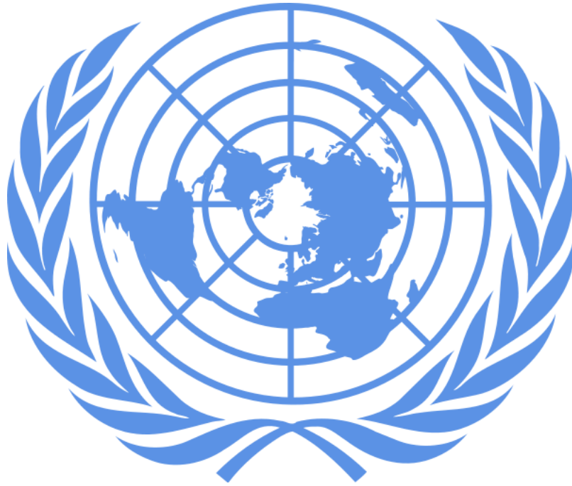
Figura8.5: O Logo das Nações Unidas usa a projecção Equidistante Azimutal.
