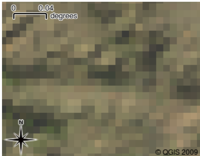
Obr. 2.13: Stejná rastrová data, ale tentokrát přiblížená. Zde můžete vidět povahu mřížky dat.
