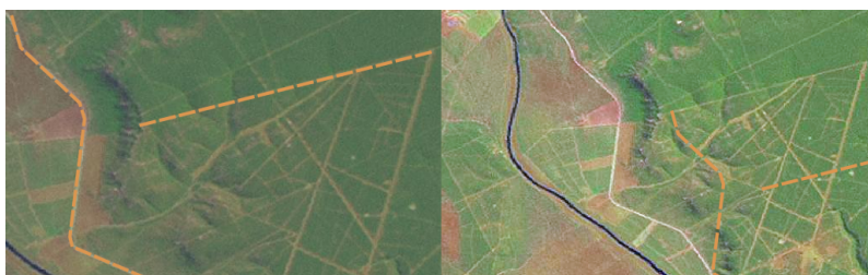
Obr. 5.9: Důležitost použití správně geograficky rastrových obrázků pro heads-up digitalizace. Na levé straně vidíme, že je obraz správně georeferencován a silniční prvky (oranžově) se překrývají dokonale. V případě, že obraz je špatně georeferencován (jak je znázorněno na pravé straně), funkce nebudou dobře zarovnané. Ještě horší je, pokud obrázek na pravé straně slouží jako referenční při pořizování nových funkcí, nově zachycená data budou nepřesná!
