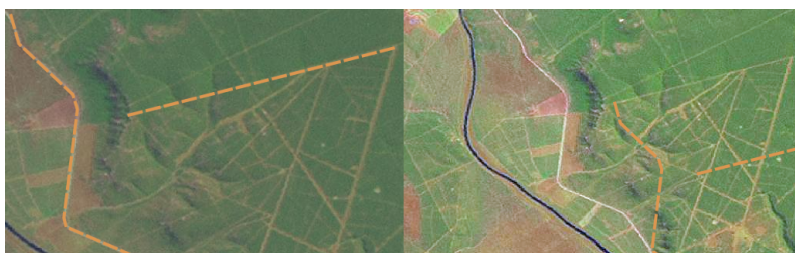
Рис. 5.9: Важность использования правильно привязанных изображений при экранной оцифровке. Слева находится правильно привязанное изображение, объекты слоя дорог (показаны оранжевым) хорошо совмещаются с подложкой. Если изображение привязано неправильно (как на рисунке справа) объекты не будут совмещаться. Ещё хуже, когда это изображение используется для оцифровки новых объектов, ведь созданные объекты будут неправильными!
