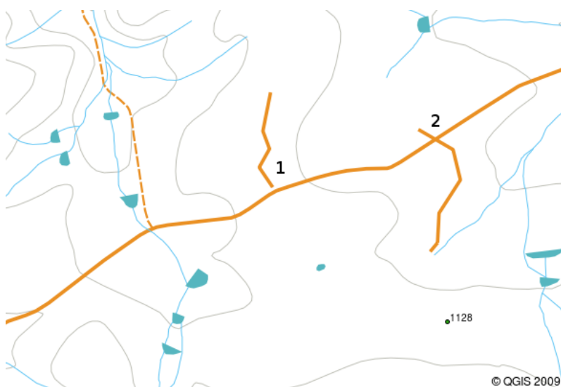
Figura 3.13: A suspensão (1) ocorre quando linhas vectorizadas que deviam ligar-se uma à outra não entram efectivamente em contacto. A transposição (2) ocorre quando uma linha termina para além da outra à qual se deveria ligar.
