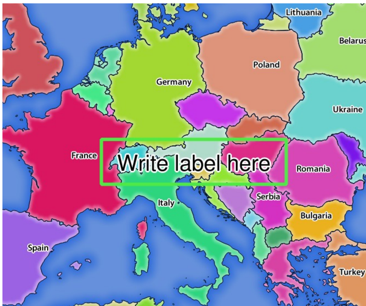
Figura3.22: Resposta do servidor a uma solicitação GetMap com parâmetros de linha vermelha
