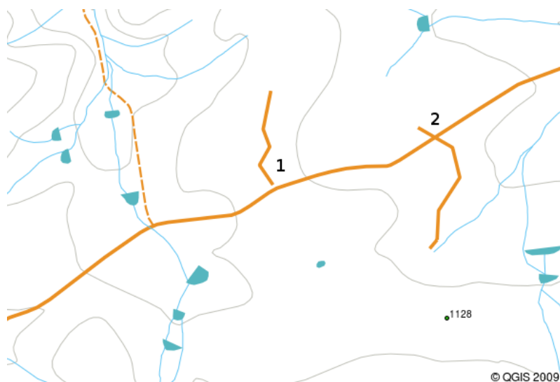
Figura3.13: Ante passagens (1) ocorrem quando digitalizado um vetor de linha que deveria se conectar a outra mas estas não se tocam. Ultrapassagens (2) acontecem se uma linha termina adiante da linha à qual deveria estar conectada.
