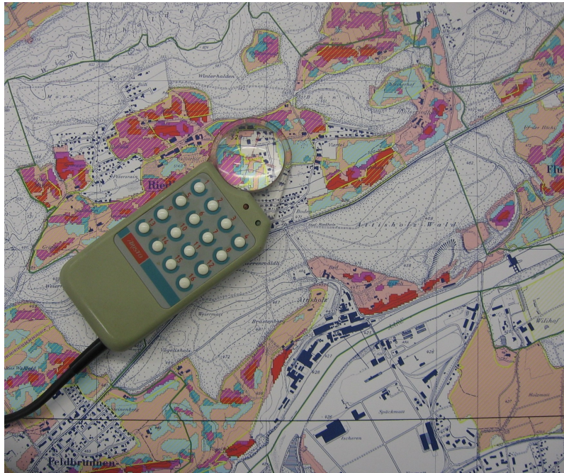
그림 5.8: GIS 전문가들은 기존 지도에서 객체를 디지털화하기 위해 디지털 테이블과 픽을 사용합니다.
