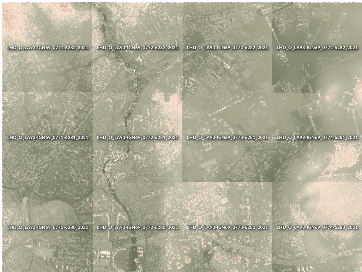
그림 20.12: Individual point cloud tiles loaded, with artefacts on edges
