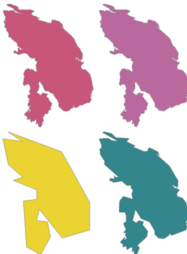
図 28.105: 左上から時計回りに、ソースレイヤと、簡素化許容値を順に大きくした結果
