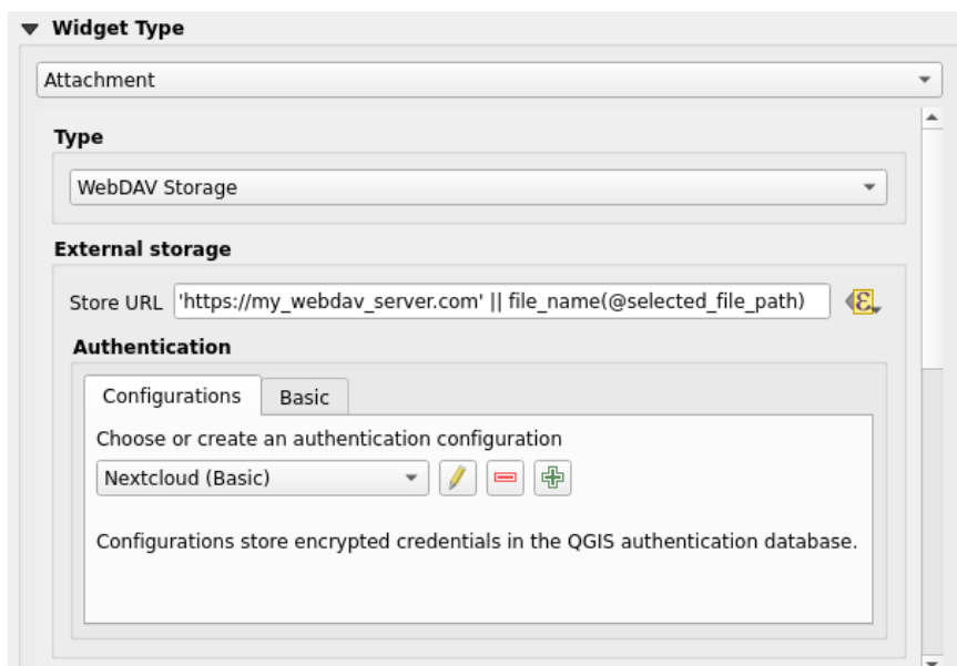
図 16.75: 指定したフィールドの WebDAV 外部ストレージの設定編集
