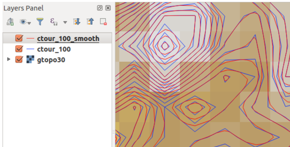
Fig. 26.7: GRASS modulo v.generalize per smussare una mappa vettoriale
