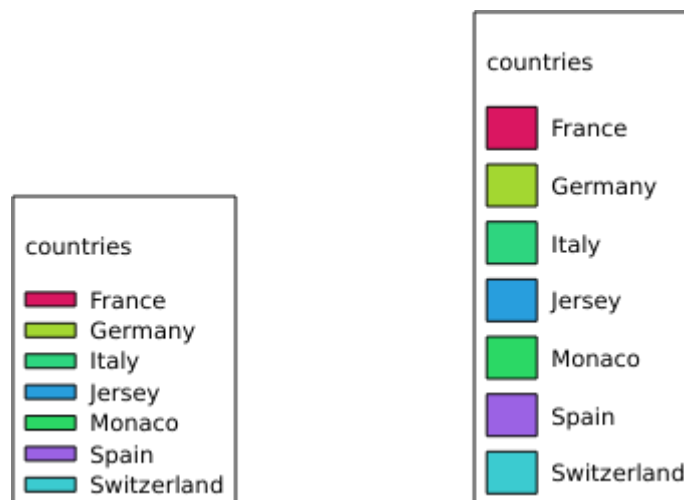
Figura 3.12: A la izquierda SYMBOLHEIGHT=2 y a la derecha SYMBOLHEIGHT=6
